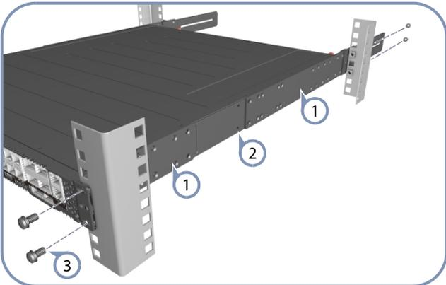
① 利用四個所附之托架螺絲，將前柱和後柱托架安裝在交換器上。
