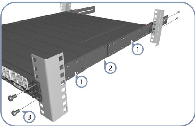
① 使用四个随附的支架螺丝将各个前柱和后柱支架安装到交换机。
